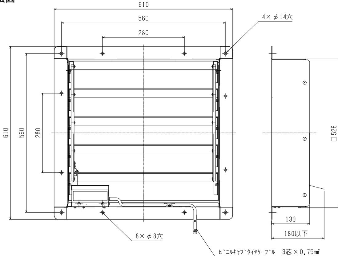
※電源コードは有圧換気扇と共締めした時、有圧換気扇の枠から約1m出ます。
