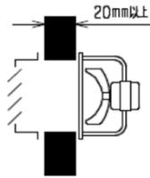
図1 羽根が据付面から出ない場合
