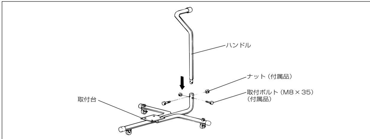
2. 取付台に本体をのせ、取付ボルト (M8 × 20) で確実に締付けてください。
